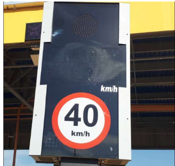
Figura 17 – Indicador de velocidade da lombada eletrônica
