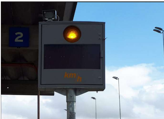
Figura 16 – Indicador de velocidade da lombada eletrônica
