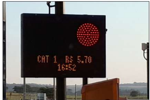
Figura 8 – ITSL – Indicador de Tarifa e Semáforo de Liberação
