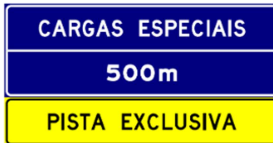
Figura 9 - Sinais de passagem de cargas especiais – 500m (PP-4)
