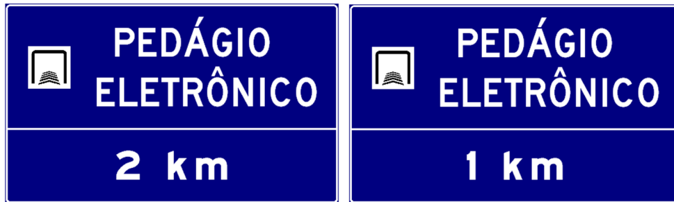
Figura 8 - Sinais de aproximação do Pedágio Eletrônico (PP-2 e PP-3, respectivamente)
